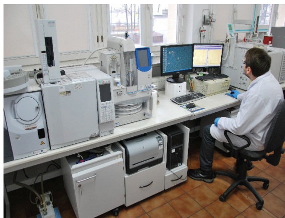
Rys. 8.3.8. Chromatografia gazowa GC-MS; Laboratorium WIOŚ; Rzeszów 2013 (źródło: [25])
