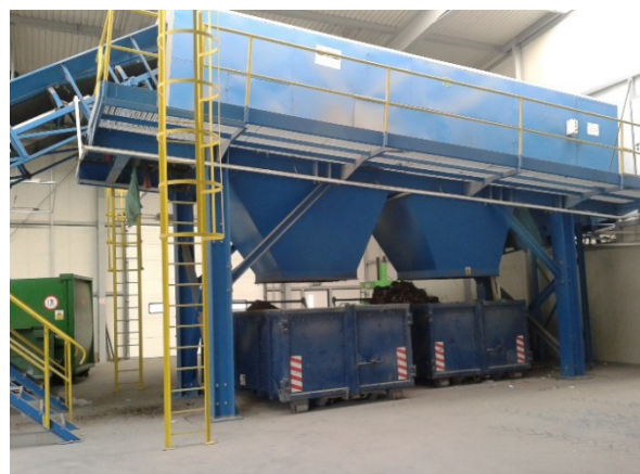
Rys. 7.1.2.4. Kabiny sortownicze w sortowni zmieszanych odpadów komunalnych; Sigetki, pow. niżański 2013 r. (źródło: [25])
