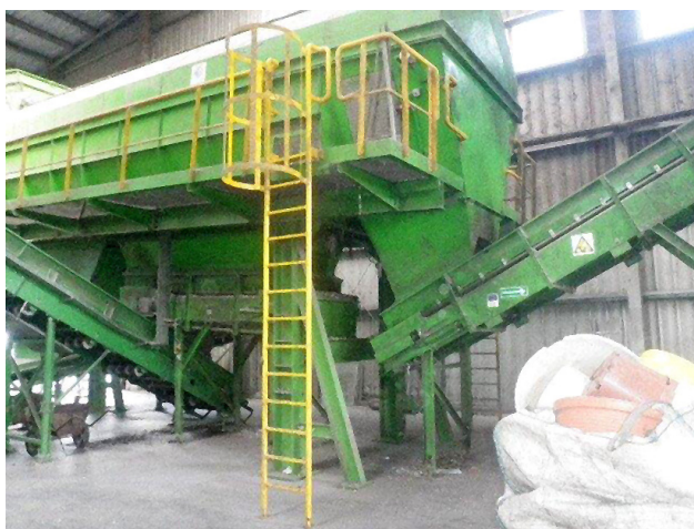
Rys. 7.6.2.1. Sito bębnowe do mechanicznego przetwarzania zmieszanych odpadów komunalnych w Hali Zakładu Unieszkodliwiania Odpadów Komunalnych; Krosno 2013 r. (źródło: [25])
