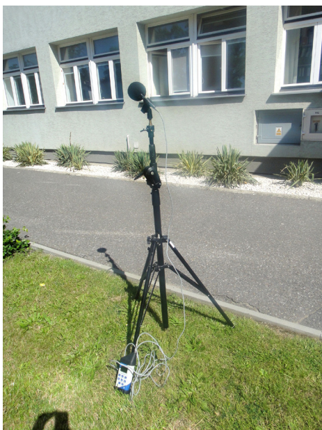
Rys. 4.2.2.1. Zestaw do pomiaru dźwięku (źródło: [25])
