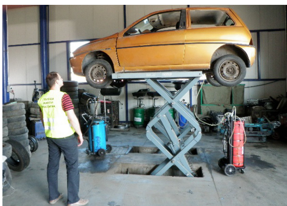
Rys. 7.5.1. Osuszanie pojazdu przed dalszym demontażem, stacja demontażu pojazdów; Straszęcin, pow. dębicki 2013 r. (źródło [25])
