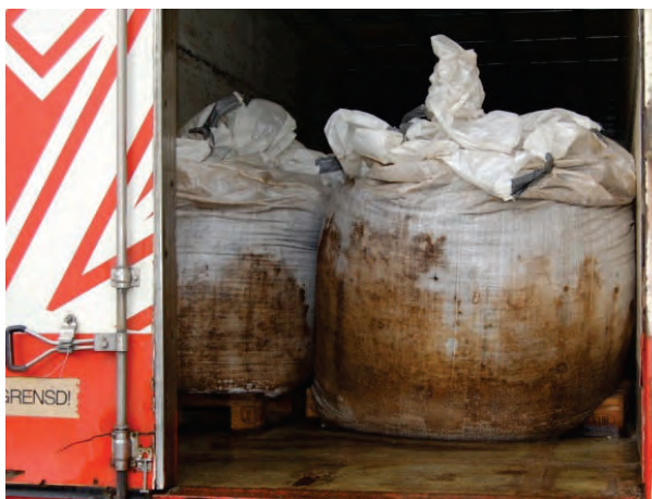
Rys. 9.3.4. Przewóz odpadów niebezpiecznych (pestycydów) w opakowaniach typu worki widoczne wycieki pod opakowaniami (źródło: [30])
